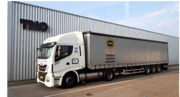
Todos los camiones fueron probados en condiciones comparables, conducidos en la misma ruta (con desplazamiento urbano, rural y en autopista) con dos cargas útiles diferentes. Las emisiones del tubo de escape se midieron mediante un sistema portátil de medición de emisiones (PEMS).
